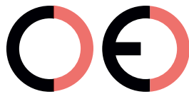
Virheellinen CE-merkki (liian kaukana)
